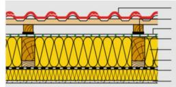
Dacheindeckung auf Lattung Vario AntiSpike Nageldichtband Integra ZUB Zwischensparren-Unterdeckbahn Sparren (evtl. mit Aufdoppelung) Integra ZKF 1-032 Zwischensparren-Klemmfilz Vario KM Duplex UV Klimamembran Integra UKF-032 Untersparren-Klemmfilz verputzte Rigipsplatte
